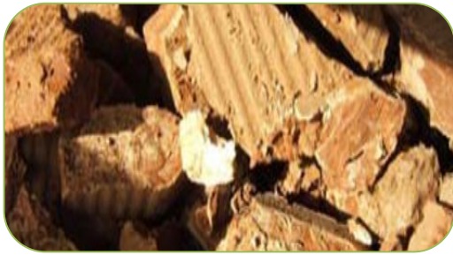
Figura 58 - Lamas residuais com alto conteúdo de ferro
