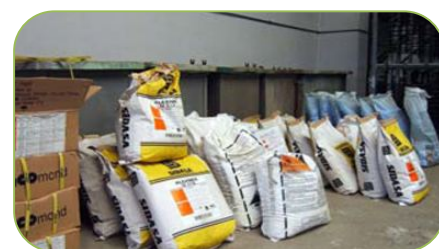
Figura 28 - Armazenamento de sais metálicos numa empresa de tratamento de superfícies
