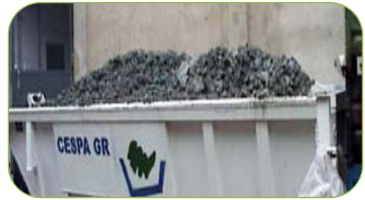
Figura 59 - Lamas residuais com alto conteúdo de crómio trivalente
